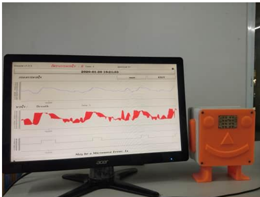
ภาพที่ 5.1 ระบบวิเคราะห์อัตราการหายใจด้วยไมโครเวฟเซ็นเซอร์
