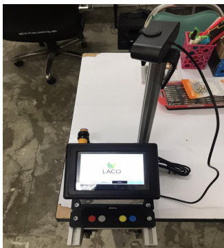
ภาพที่ ก.3 ระบบตรวจวัดขนาดและนับจำนวนกล่องบรรจุภัณฑ์ตัวพัฒนาโดยใช้เลเซอร์วัดระยะรวมกับการประมวลผลภาพ
